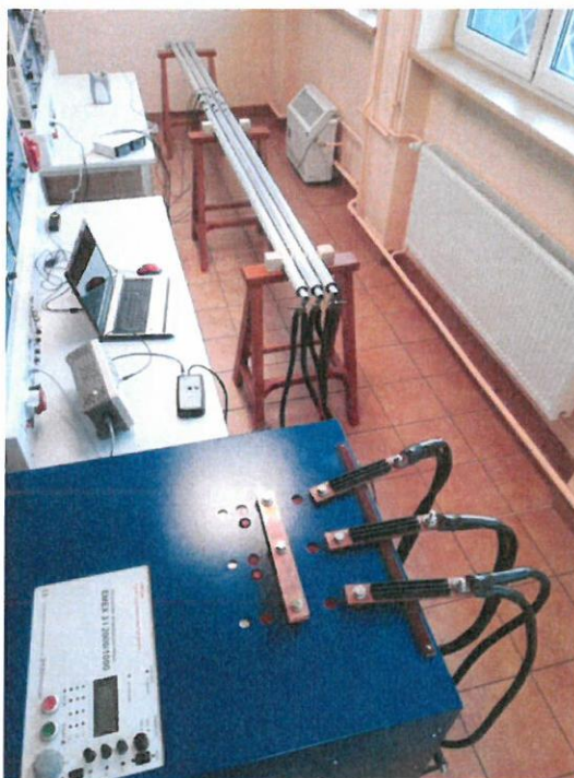
Rys. 1.10. Autorskie stanowisko do badania szynoprzewodów w laboratorium inżynierii elektroenergetycznej w Instytucie Inżynierii Środowiska Politechniki Częstochowskiej
