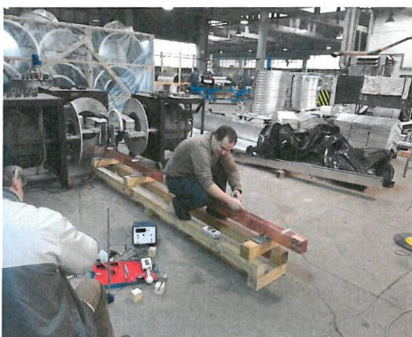
Rys. 1.34. Pomiary pola magnetycznego dla szynoprzewodu nieekranowanego
