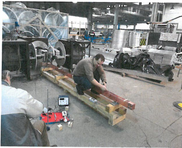
Rys. 1.34. Pomiary pola magnetycznego dla szynoprzewodu nieekranowanego
